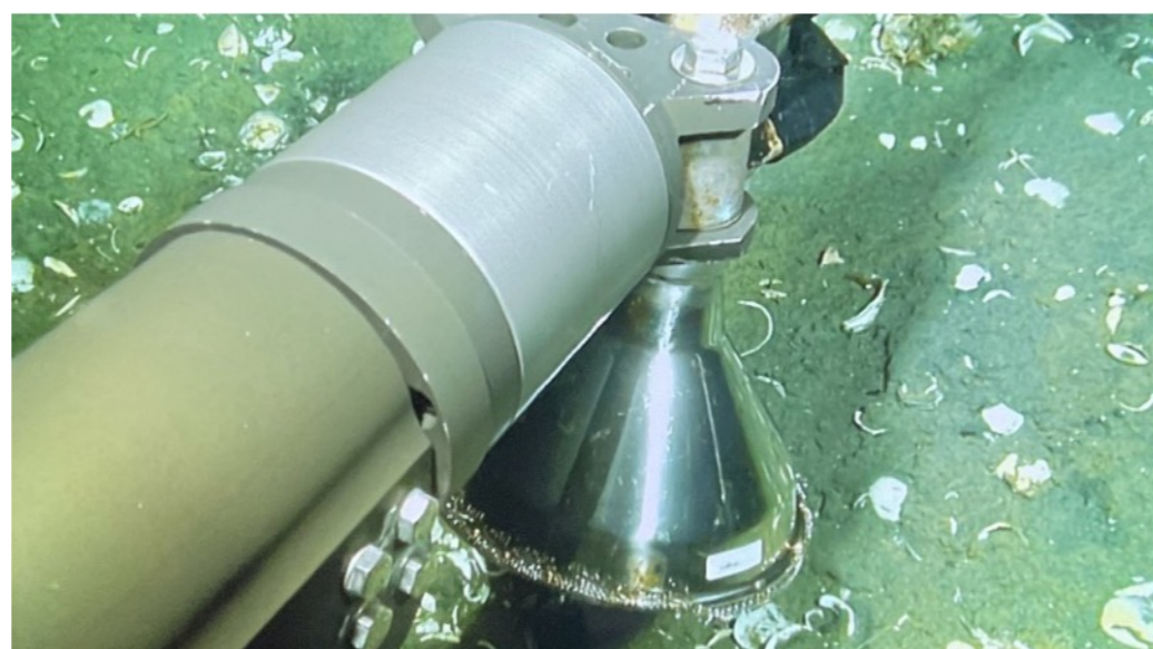
気泡捕集器を位置決めするROVアーム
