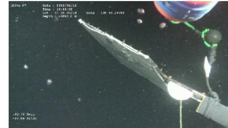
図-7 メタンハイドレートの付着の確認後、平板の角度を変化させる
