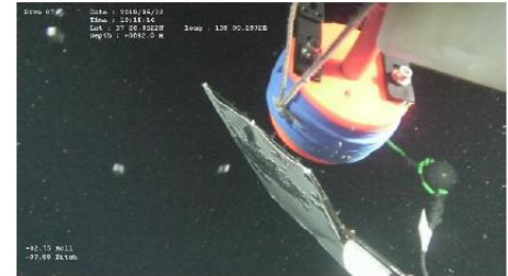
図-8 メタンハイドレートが膜材から剥離した際の角度を測定する。
