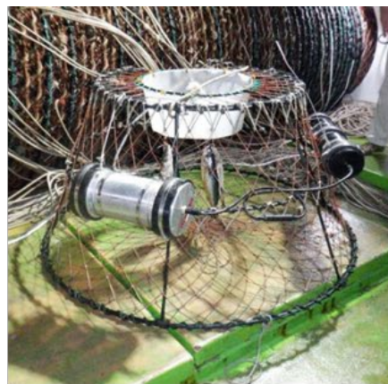
図3 カニかご漁概念図(左)、スピーカーを取り付けたカニかご(中)、入かご数カウント(右)
