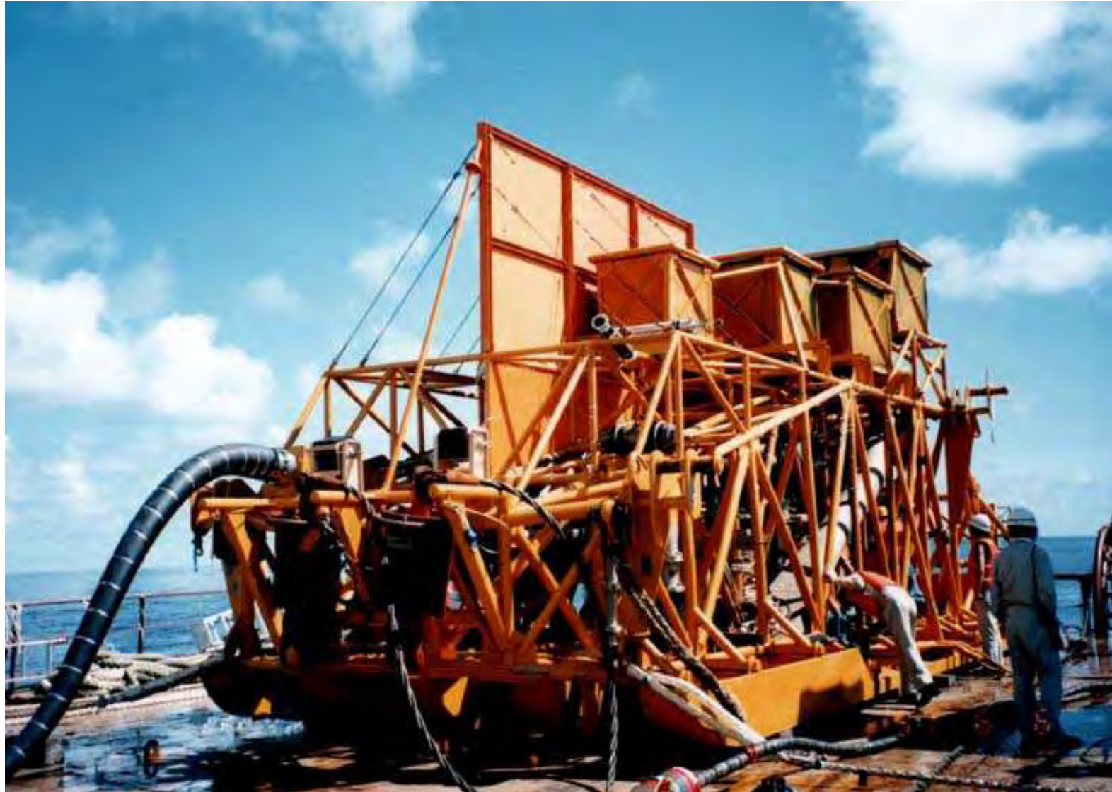
日本が1997年に水深2,200mの海山で使用したマンガン団塊集鉱実験機
